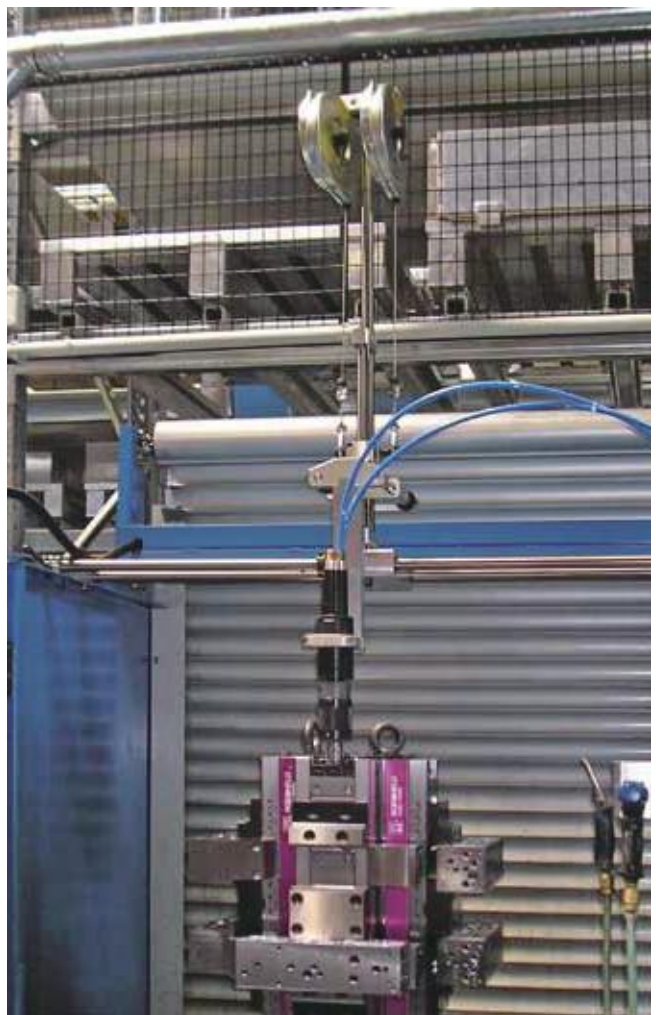
공압 클램핑 장치 사용 발 작동 스위치에 의해 클램핑 및 언클램핑 자동화 시스템에 관한 더 많은 정보는 11장 “클램핑 시스템 자동화” 참조.
