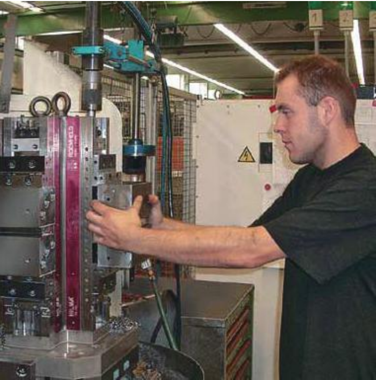
공압 클램핑 장치 사용 발 작동 스위치에 의해 클램핑 및 언클램핑 자동화 시스템에 관한 더 많은 정보는 11장 “클램핑 시스템 자동화” 참조.
