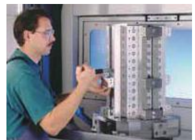
3. 클램핑 모듈은 편심 나사 및 토크 렌치 50-70 Nm를 통해 고정된다.
