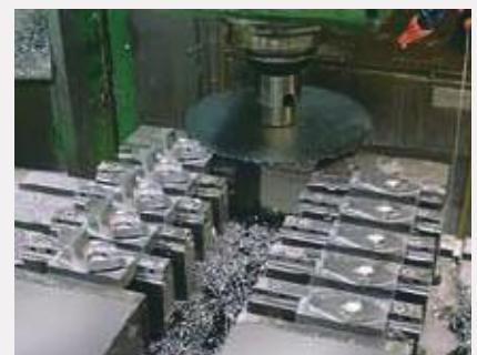
마무리 가공 후 “블록 스크랩”은 원형 밀링 절단기를 이용해 공작물에서 분리된다.
