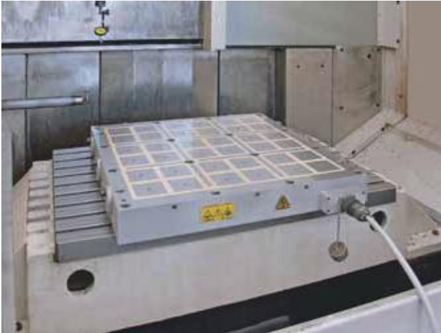
사각 폴(pole) 70 x 70을 장착한 마그네틱(Magnetic) 클램핑 플레이트, 플레이트 사이즈 630 x 630 mm, 멈춤 막대를 위한 측면 드릴 홀 있음
