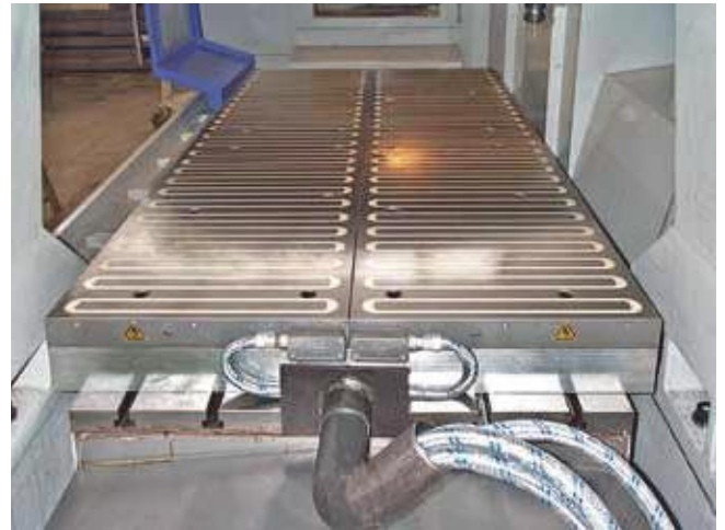
고중량 가공을 위한 긴 폴(pole), 플레이트 사이즈 2200 x 1200 mm, 2개의 연결 있음, 마그네틱(Magnetic) 유지력 800 kN.
