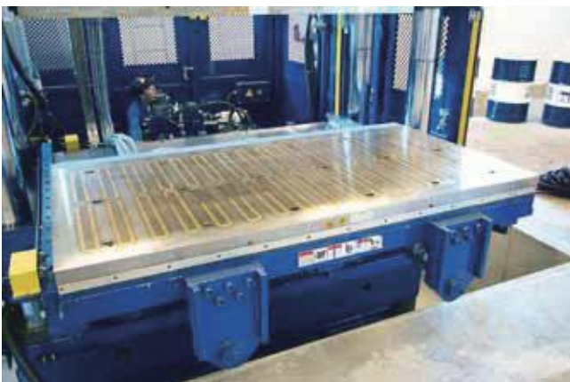
슬라이딩 테이블 2500 x 1200 mm 용 마그네틱(Magnetic) 클램핑 시스템, 유지력 800 kN, 온도범위 최대 230℃ .
