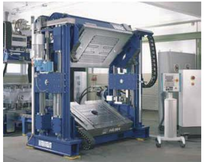
주형 캐리어 1500 x 1000 mm 용 마그네틱(Magnetic) 클램핑 시스템, 유지력 200kN, 온도범위 최대 120℃ .
