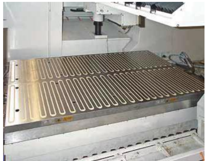
매우 작은 주형 및 특수 적용을 위해 힘을 집중시키는 긴 M-TECS LP 폴(pole)
